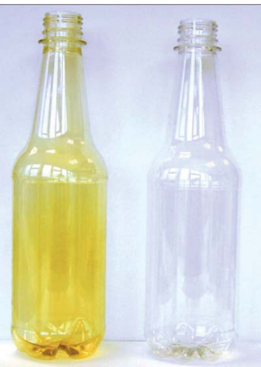
Abb. 1: Braunfärbung durch Innenbeschichtung mit Kohlenstoffverbindung im Vergleich zur SiO 2 -Beschichtung.
